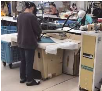
入替えた貫流式ボイラー (右端)
